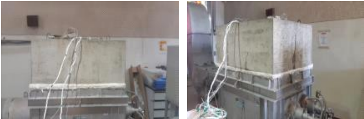
해설 그림 5.2 시험체 거치 및 단차 최소화 사례
