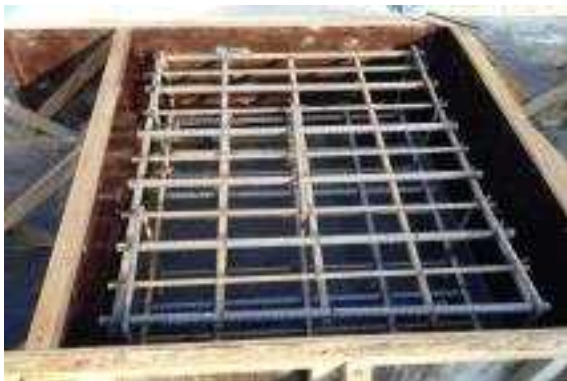
해설 그림 5.1 내화 콘크리트 시험체의 철근 배근 및 시험체 제작 사례
