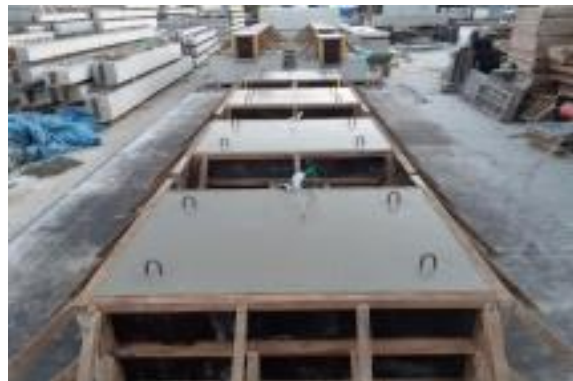
해설 그림 5.1 내화 콘크리트 시험체의 철근 배근 및 시험체 제작 사례
